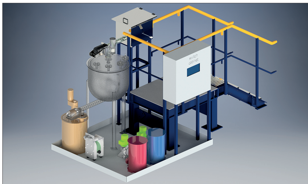
Abb. 1: Variante eines semi-automatischen Mauk-Reaktors
