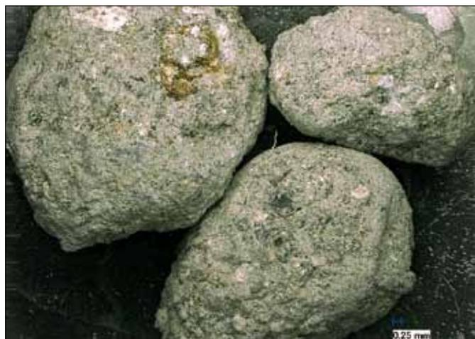
Abb. 5: NE-Metallschrott der Korngrößen 4 bis 10 mm nach Wirbelstromscheidung (20-fache Vergrößerung)
