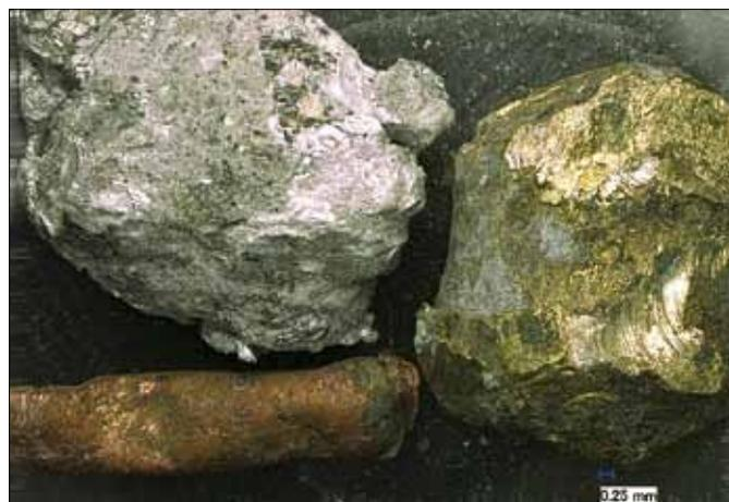
Abb. 6: NE-Metallschrott der Korngrößen 4 bis 10 mm nach weitergehender Aufschlusszerkleinerung durch eine Prallmühle (20-fache Vergrößerung)
