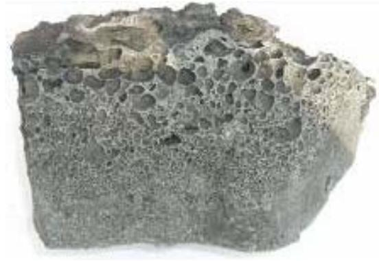
Abb. 3: Recyclingprodukte: Ni-Co-Legierung (links), seltenerdmetall-reiche Schlacke (rechts) [8]
