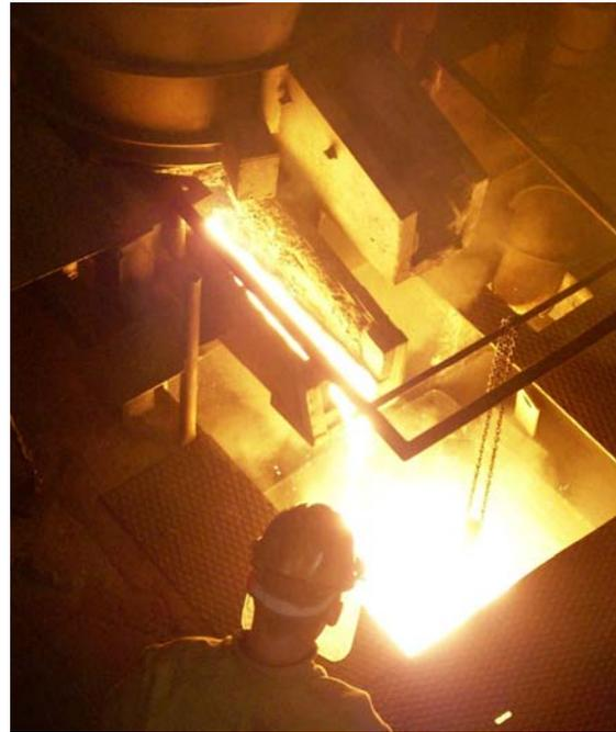
Abb. 2: Pilot-LBO am IME (links) und Schmelzeabstich nach Versuchsende (rechts) [11]
