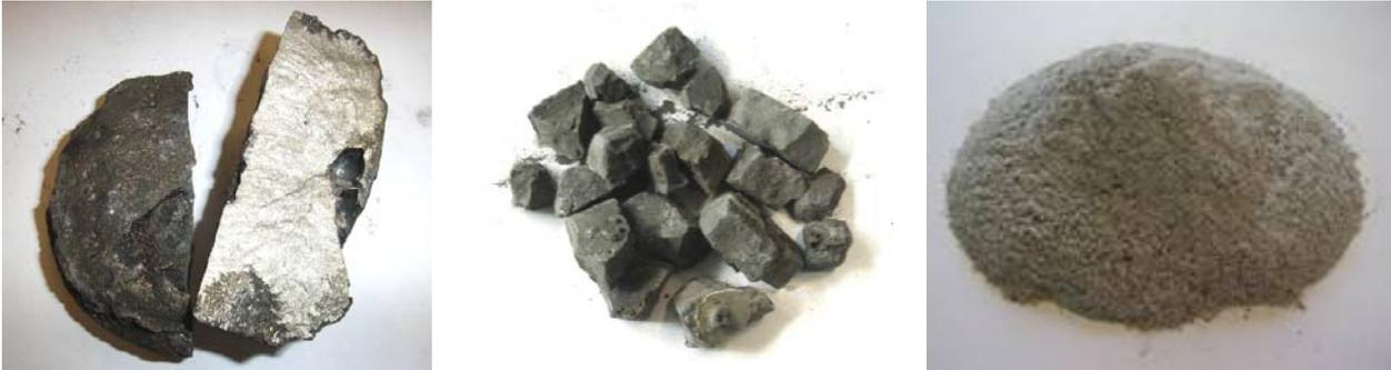
Abb. 6: Recyclingprodukte: Co-Mn-Legierung (links), Li-Konzentrate: Li-reiche Schlacke (Mitte), Li-reicher Flugstaub [8], [11]
