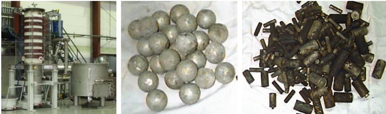
Abb. 1: Anlage der ACCUREC Recycling GmbH in Mühlheim (links), Recyclingprodukte: Cd-Kugeln (Mitte) und Cadmiumfreies NiFe-Recyclingkonzentrat (rechts) [6], [8]
