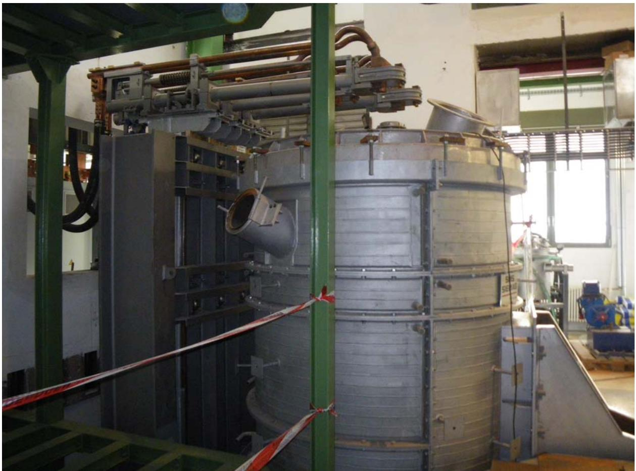
Abb. 6: im Aufbau befindlicher 1 MW Lichtbogenofen des IME (Fertigstellung Mitte 2010)
