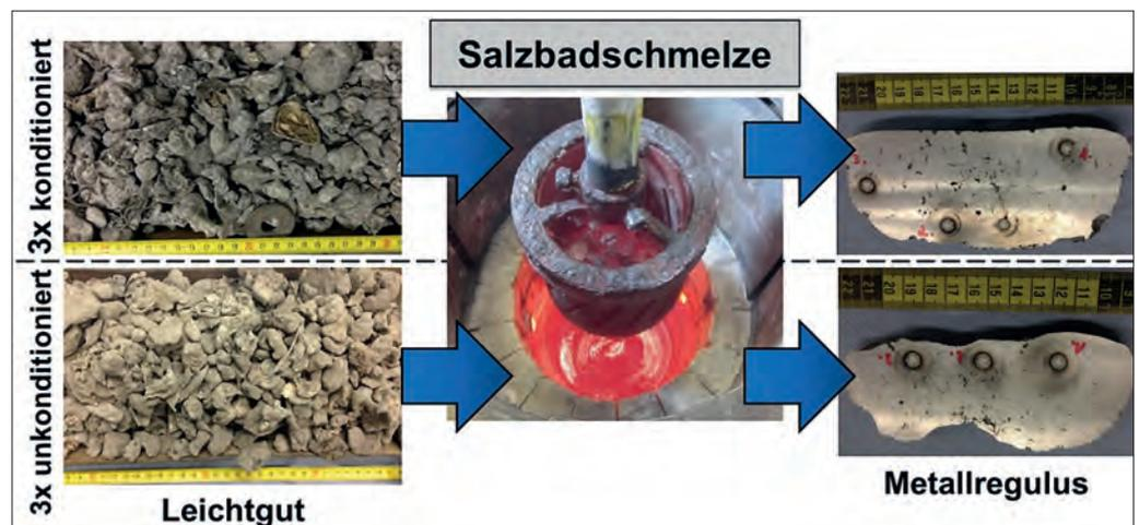
Abb. 6: Ablauf der Zentrifugen-Salzbad-trennschmelze von Leichtgut
