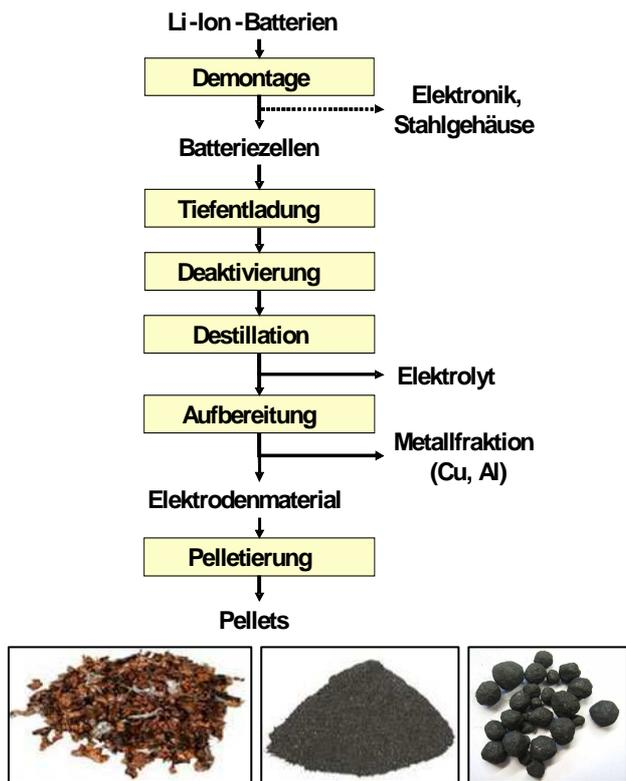
Abbildung 1: Prozesskette mechanische Aufbereitung (oben), Schredderleichtfraktion (links), Elektrodenmaterial (Mitte), pelletiertes Elektrodenmaterial (rechts)
