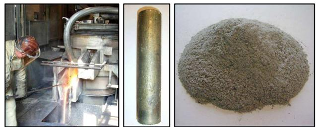
Abbildung 2: Prozesskette pyrometallurgische Aufbereitung (oben), Abstich am Elektrolichtbogenofen (links), Block Co-Ni-Mn-Legierung (Mitte), Li-reicher Flugstaub (rechts)
