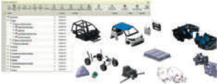
**Abb. 5.3** BOM als Struktur der virtuellen Entwicklungsumgebung
