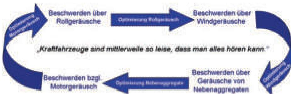
**Abb. 5.9** Prozess der Fahrzeuggeräuschoptimierung
