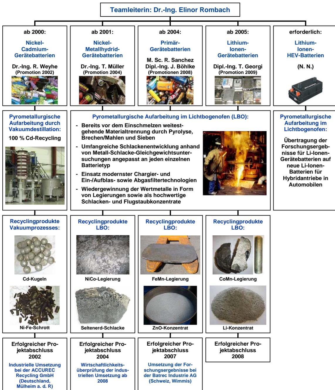
Abbildung 3: Entwicklung von Batterierecyclingverfahren am IME der RWTH Aachen
