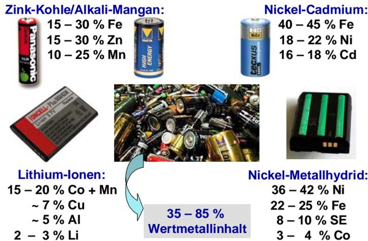
Abbildung 1: Metallinhalte derzeit gängiger Gerätebatteriesysteme
