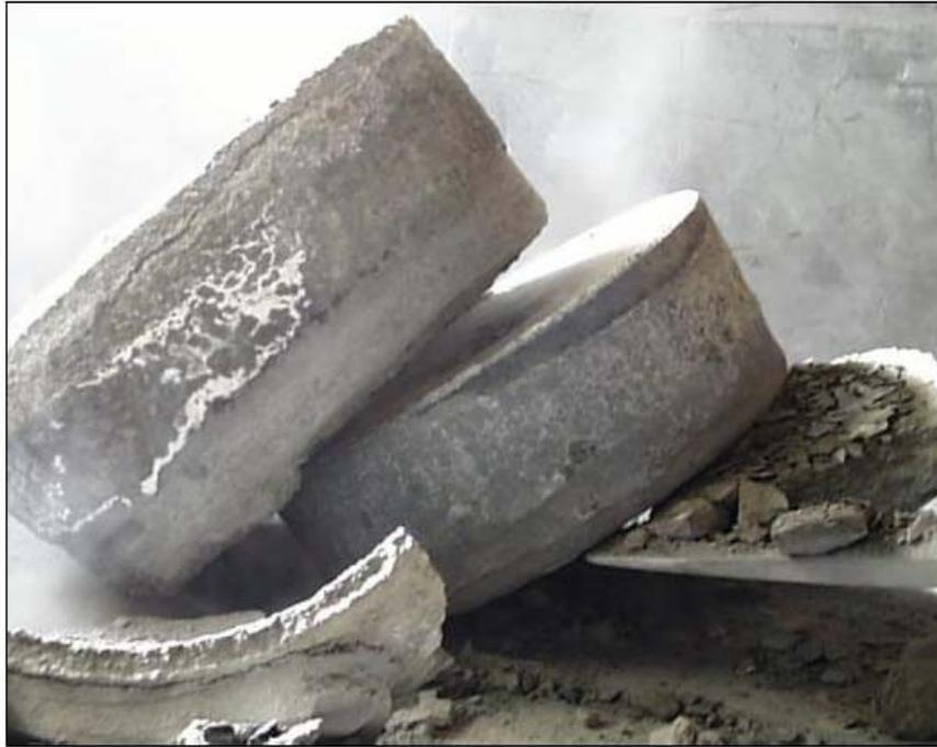
Abbildung 10: Blockmetall und Schlackenprodukt
