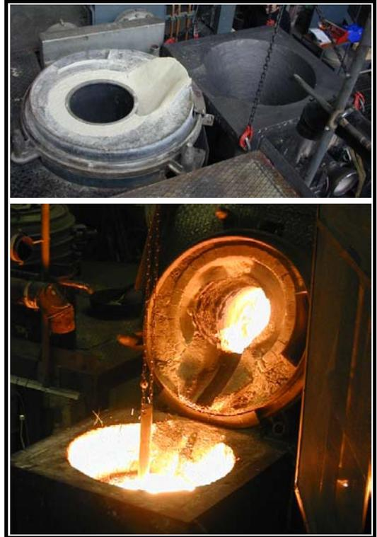
**Bild 5:** Vakuuminduktionsöfen (Fa. Junker), Schmelzvolumen 100 l, Schmelzleistung 180 kW
