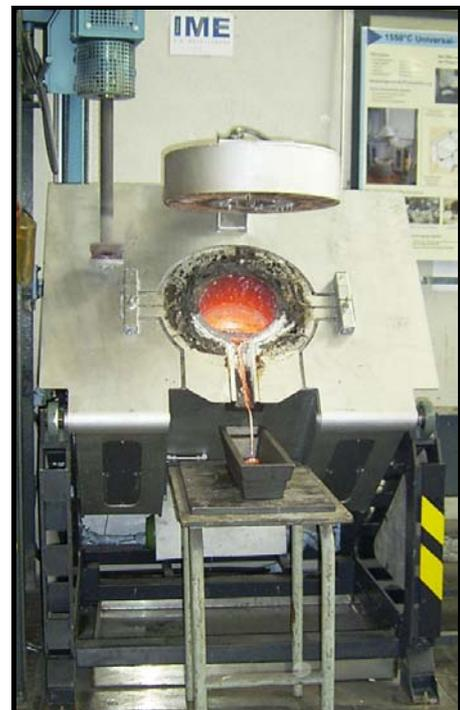
**Bild 4:** 35 | Thermostar-Ofen mit Fo-seco-Impeller und Schutzgasbetrieb
