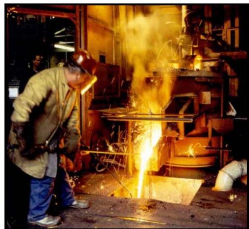
**Bild 3:** Batterierecycling (Co-Ni-Abstich)
